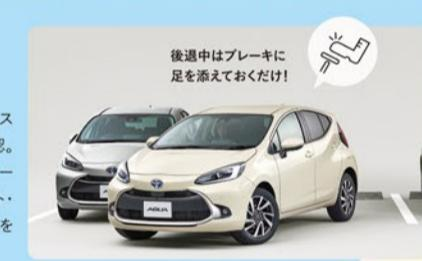
駐車したいスペースの横に停車後、アドバンスト パークスイッチを押して駐車位置<sup>\*4</sup>を確認。その後、開始スイッチを押すと、カメラとソナーで周囲を監視しながら、ステアリングシフト、アクセル・ブレーキ操作を自動化し、駐車操作をアシストして駐車を完了させます。
