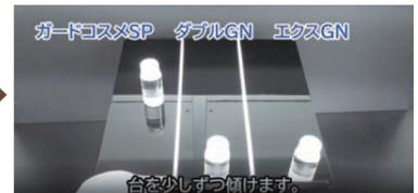
●同様に、エクスGNを施工したパネルでは僅かな傾きで瓶が滑りだし、次にダブルGNのパネルで瓶が滑りました。
