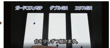
●エクスGNを施工した試験片は、僅かな傾きで即座に水滴が流れはじめ、次にダブルGNの試験片が流れました。
